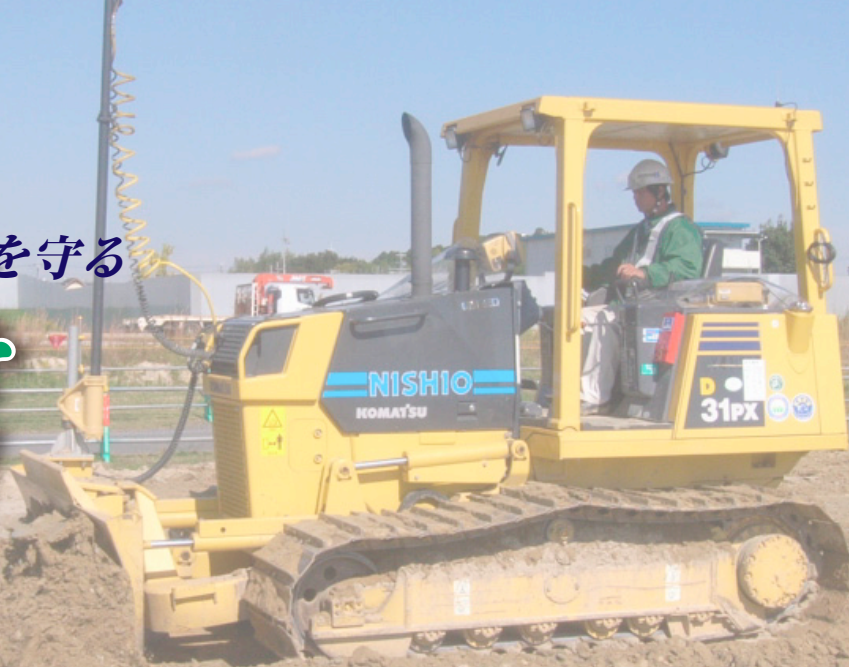
ブルドーザ（3次元マシンコントロール） （写真提供：国営飛鳥歴史公園事務所）
