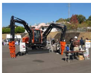
2本腕のロボット建設機械 「ASTACO」
