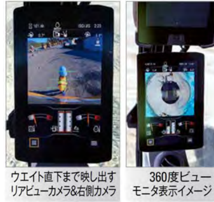
図-4 リアビューカメラと右側カメラ・モニタ<CAT>
