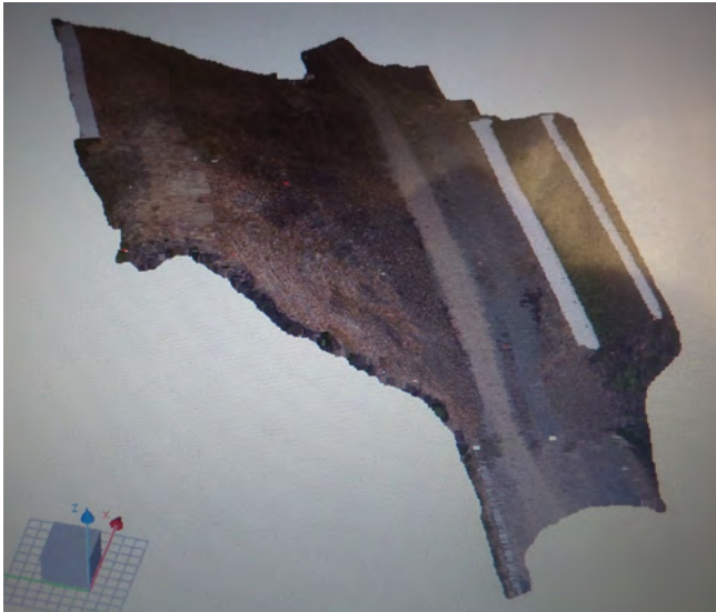
図-6 起工測量3次元測量結果
