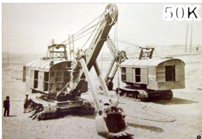
写真-1 国産初の電気式ショベル 50K 型
