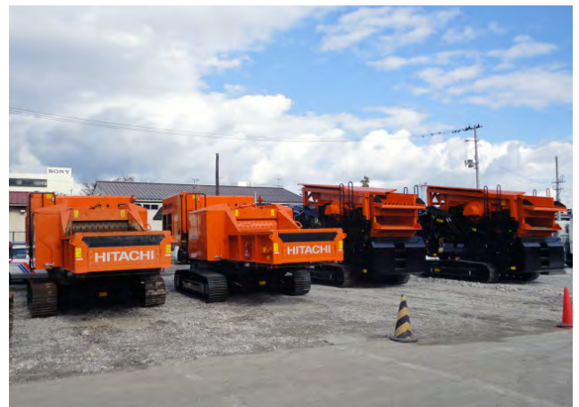
災害現場へ出荷前の木材破砕機と振動篩機
