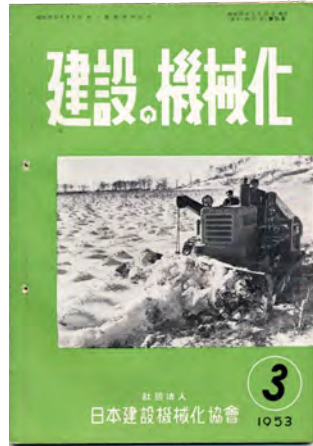
第 37 号表紙写真 北海道釧路にて除雪作業中の ディーゼル・アングルドーザ
